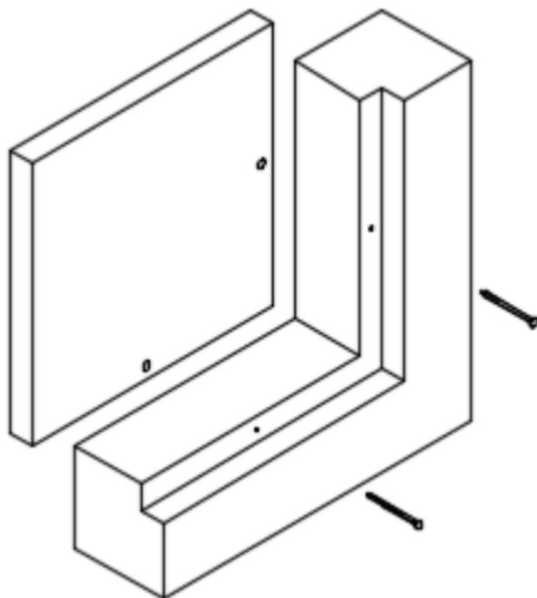
El ensamble no se ha detallado por motivos de claridad en el dibujo. Puede ser machihembrado, inglete, etc.
